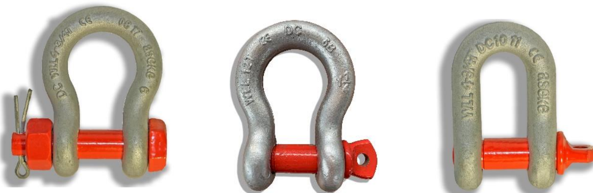
H-sjakkell med mutterbolt, H-sjakkell med øyebolt og D-sjakkell med øyebolt.
